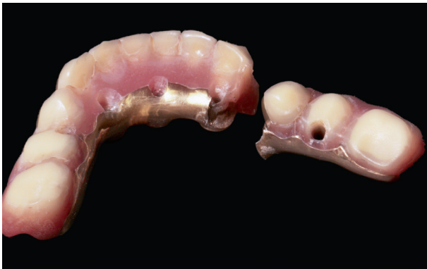
2 Armature fracturée ; fracture de fatigue due à des pressions occlusales mal réparties du fait de l'usure des dents du commerce.
